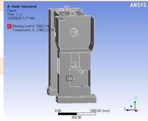
Şekil 3. Pres gövdesinin aksi tarafına yatay kardan mili yataklanmasında aşağı doğru kuvvet uygulanması
