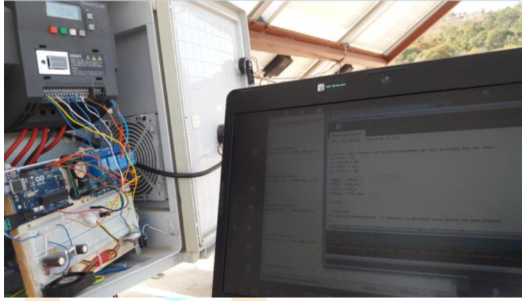
Şekil 2.8 Arduino tabanlı çok çıkışlı kontrol (zamanlayıcı) devresinin solar sistem üzerinde test edilmesi.
