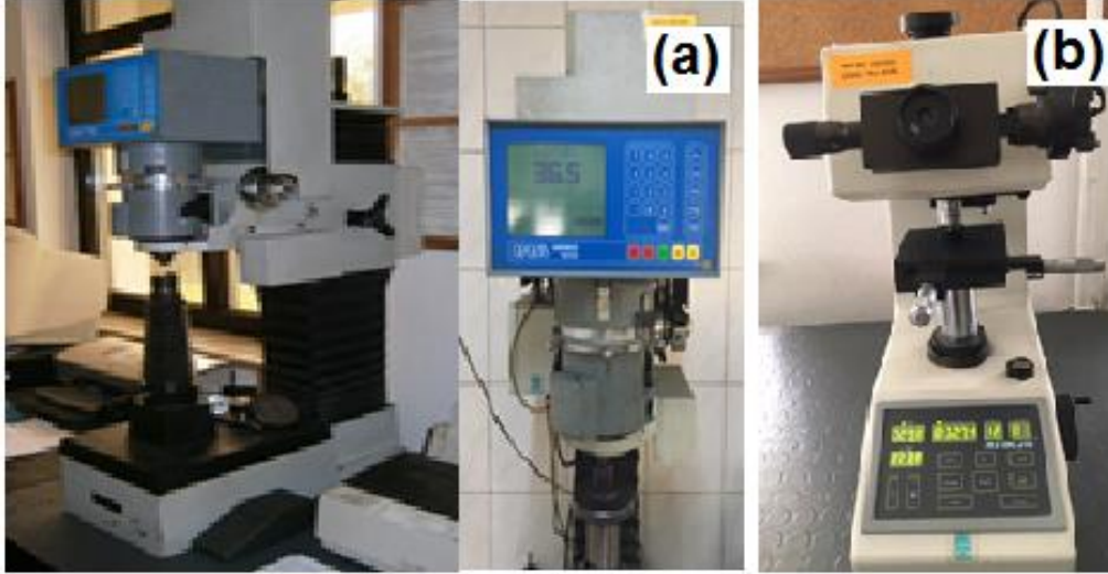
Şekil 2.4 Sertlik cihazları a) Rockwel-C b) Mikro Vickers
