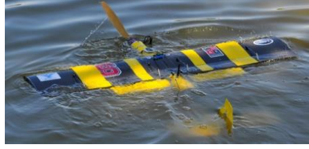
Şekil 1.11. Üretilen ilk sabit kanatlı insansız hava – sualtı aracı prototip testi (Weisler vd., 2018)
