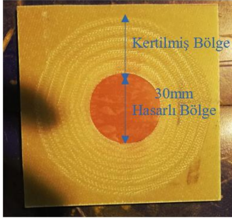
Şekil 6 Tamir için hazırlanan numune örneği
