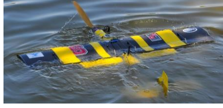
Şekil 1.11. Üretilen ilk sabit kanatlı insansız hava – sualtı aracı prototip testi (Weisler vd., 2018)
