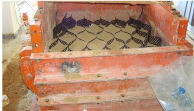
Şekil 1. Geocellin kum ile doldurulması
