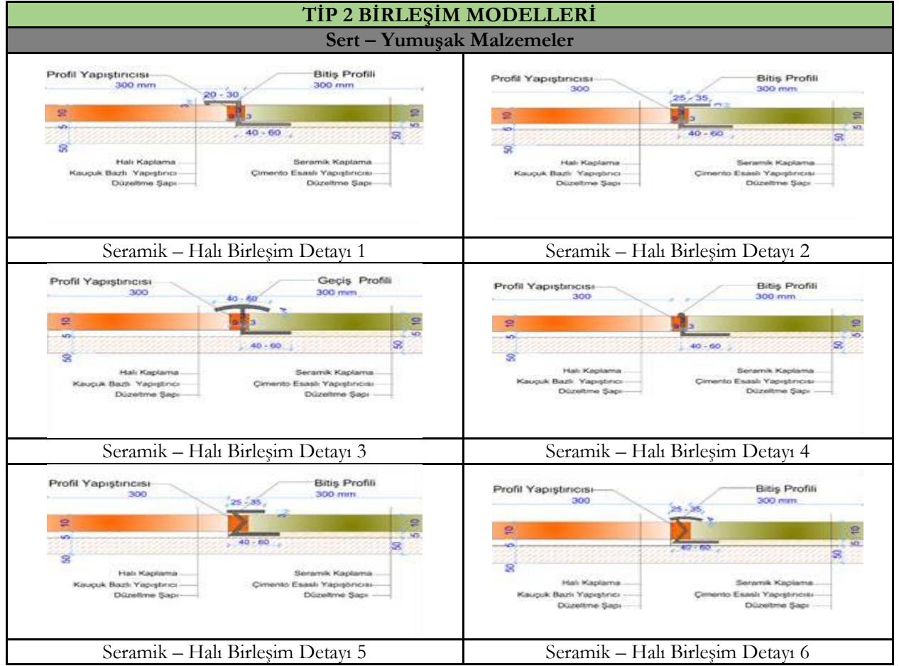
Şekil 22. Sert-Yumuşak Farklı Döşeme Kaplaması Geçiş Tip Önerileri
